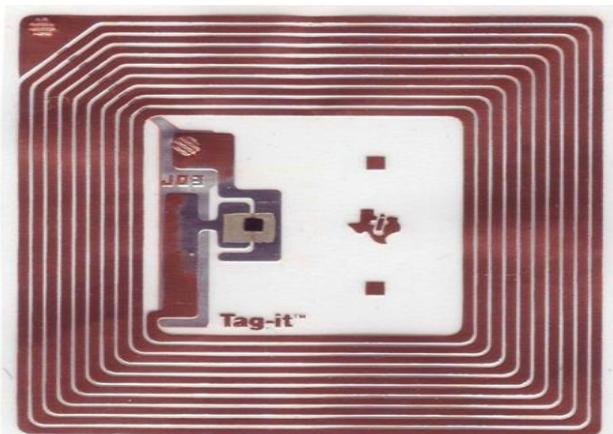
Slika 1: RFID Tag - poseduje mali čip i bakarnu antenu
